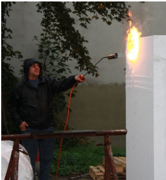
Imagen: Bloque para construcción de EPS cuando se le aplicó la llama
