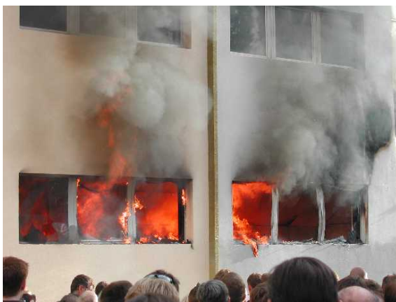
Imagen: Ensayo de fuego en fachada (después de 27 min.)
